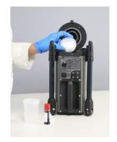
エアーサンプリング ADC-200 ボブキャット(Bobcat™)は独自のドライフィルターを採用し、三脚を装填した小型軽量なポータブルタイプのエアーサンプラーです。毎分100Lから200Lのエアーを能動的にサンプリングし、ウイルスや細菌、カビの胞子をフィルター上に捕集します。フィルターからサンプル液への溶離回収はわずか数秒で行われ、6mLの液体サンプルに濃縮され、そのままPCRなどの分子的手法を用いて分析が可能です。
