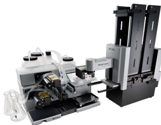
BioStack は BioTek 社製マイクロプレートウォッシャーや分注機、プレートリーダーに接続可能な、コンパクト設計のマイクロプレートスタッカーです。処理速度を増やすため、プレート搬送速度を高められました。BioStack はウォッシャーなどの操作キーパッドが操作しやすくするため、回転式グリッパーを装備しています。BioStack は 405™ Touch や 405LS, EL406™, MultiFlo™ FX, MultiFlo™ とコンピュータを介さず直接制御が可能です。
